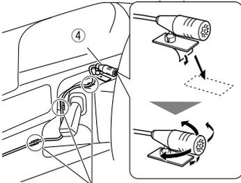
Befestigen Sie das Kabel mit handelsüblichem Klebeband.
