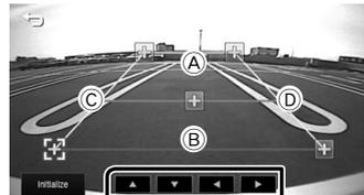
Stellen Sie sicher, dass die Linien A und B horizontal parallel zueinander stehen und dass die Linien C und D gleich lang sind.
