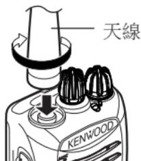
拿住天線底座，按順時針方向將天線旋入對講機頂部的接頭中，直到旋緊為止。
