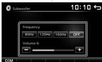
**Frequency** Ajuste de filtro de passa baixos. / [80Hz], [120Hz], [160Hz], [OFF]: Desativa a saída do subwoofer. (Padrão DESLIGADO)
