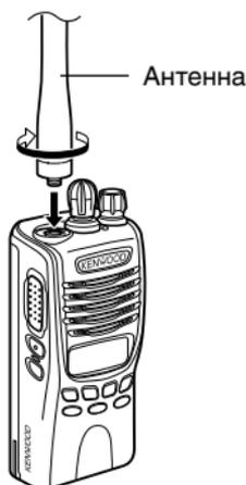
Вкрутите антенну в разъём в верхней части трансивера, удерживая антенну за основание и вкручивая по часовой стрелке до упора.
