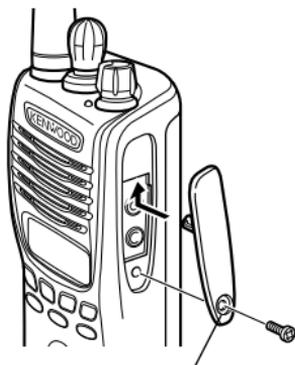
Заглушка гнезда для подключения динамика/микрофона
