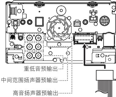
在连接至外部放大器时，将其接地导线连接至汽车底盘，以避免损坏本机。
