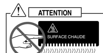
Ne touchez pas à la surface métallique de l'émetteur-récepteur en état de fonctionnement.
