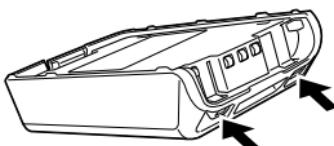
2 Insérez 6 piles alcalines AA (LR6) dans le boîtier piles.
