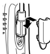
**3** Tout en maintenant le crochet de blocage en place, poussez-le vers la base de l'émetteur-récepteur jusqu'à ce que les languettes sur le crochet s'emboîtent.
