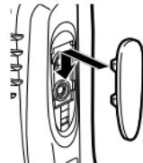
**2** Tout en maintenant le cache en place, poussez-le vers la base de l'émetteur-récepteur jusqu'à ce que les languettes sur le cache s'emboîtent.
