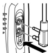
**2** Placez le crochet de blocage au-dessus des fiches du microphone à haut-parleur de sorte que les languettes de blocage s'insèrent dans les rainures de l'émetteur-récepteur.
