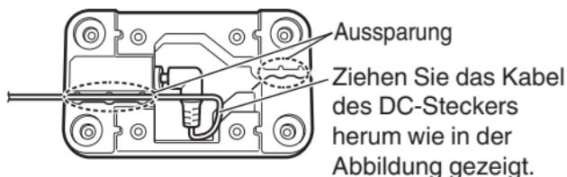
\* In dieser Abbildung ist das Kabel in die linke Aussparung eingelegt.
