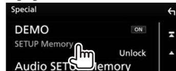
**Pour déverrouiller le réglage :** Touchez **[SETUP Memory]** pour sélectionner **[Unlock]**.
