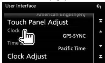
**[GPS-SYNC]** Synchronise l'heure de l'horloge avec le GPS.
