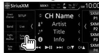
L'appareil démarre le balayage. (L'indicateur Scan s'allume.)
