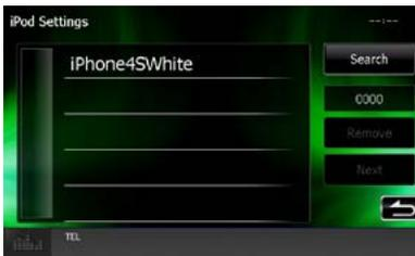
Если подключаемое устройство Bluetooth не отображается, коснитесь кнопки [Search] (Поиск) и выполните соединение устройств.
