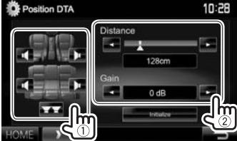
**<Distance>** Настройка значения цифровой регулировки запаздывания (DTA).
