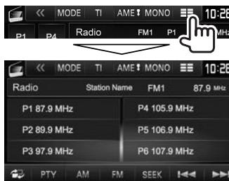
Отображаются список запрограммированных станций и название станции для FM Radio Data System (когда принимается сигнал PS).
