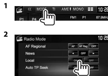
Устройство настраивается только на радиостанции с достаточным уровнем сигнала. Загорается индикатор LOS.
