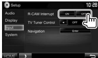
[ON] Отображение картинки с камеры заднего вида при переключении коробки передач на задний ход (R).
