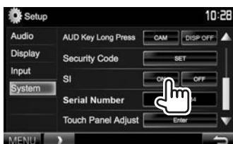
Индикатор безопасности на панели монитора мигает при выключении зажигания автомобиля.
