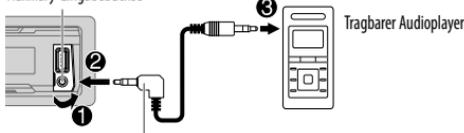
3,5-mm-Stereo-Minstecker mit "L"-förmigem Anschluss
