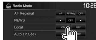
O aparelho sintoniza apenas as estações com sinais suficientemente fortes. O indicador L.O.S acende-se.
