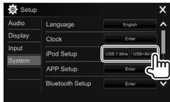
**[USB 1 Wire]** Da selezionare quando l'iPod o l'iPhone è collegato con il cavo KCA-iP102 o KCA-iP103 (da acquistare a parte).
