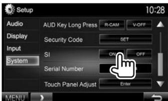
O indicador de segurança no painel do monitor começa a piscar quando a ignição do veículo é desligada.
