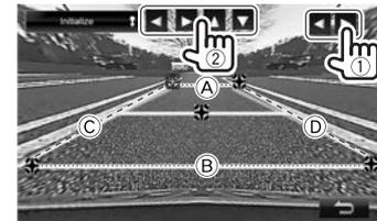
Stellen Sie sicher, dass **(A)** und **(B)** horizontal parallel sind, und dass **(C)** und **(D)** die gleiche Länge haben.
