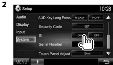
Die Sicherheitsanzeige im Monitorfeld blinkt, wenn die Fahrzeugzündung ausgeschaltet ist.
