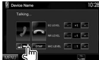
Bei jedem Drücken der Taste schaltet die Sprechmethode um (☎️↔️☎️ : Handfrei-Modus / ☎️↔️☎️ : Telefon-Modus).
