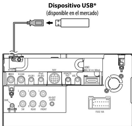
\* Si es necesario, prolongue el cable mediante CA-U1EX. (Máx. 500 mA, 5V)
