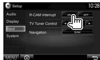
**Para desactivar:** Seleccione [OFF] para <R-CAM Interrupt>.
