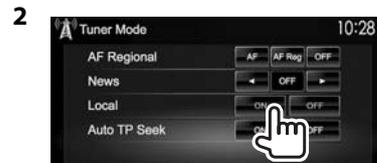
[ON] Selecciónelo para sintonizar solamente emisoras con una señal suficientemente fuerte. El indicador LOS se enciende.
