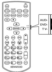
**Modo AUD:** Cambie a este modo para controlar una fuente seleccionada o una fuente de sintonizador, etc.
