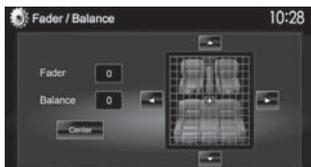
**Fader:** Ajusta el balance de salida de los altavoces delanteros y traseros.
