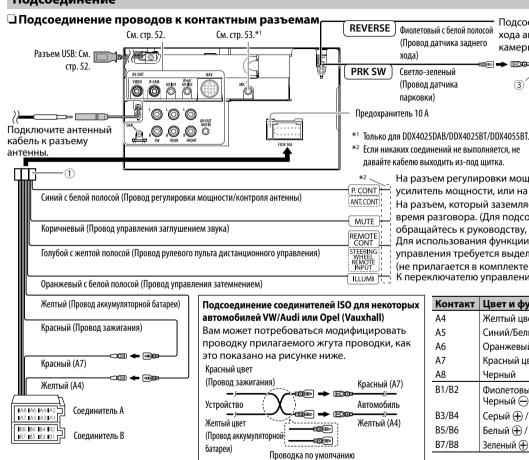
Подсоедините к жгуту проводки лампы заднего хода автомобиля при использовании опционной камеры заднего вида.
