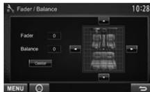
**Fader** : Ajustez la balance de sortie avant-arrière des enceintes.
