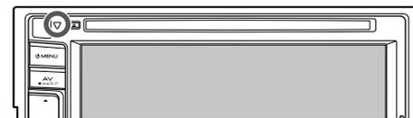
Si l'appareil ne fonctionne pas correctement, appuyez sur la touche de réinitialisation. L'appareil retourne aux réglages d'usine une fois la touche de réinitialisation enfoncée (sauf pour les périphériques Bluetooth enregistrés).
