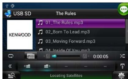
Die von einem grünen Quadrat eingefassten Tasten stehen für die Sprachsteuerung zur Verfügung.
