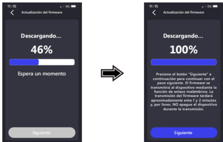
5. Una vez que se complete la transferencia, presione "Actualizar" en su teléfono y el dispositivo comenzará el proceso de actualización. No desconecte la alimentación eléctrica del dispositivo durante ese tiempo. La actualización tardará aproximadamente entre 1 y 2 minutos.
