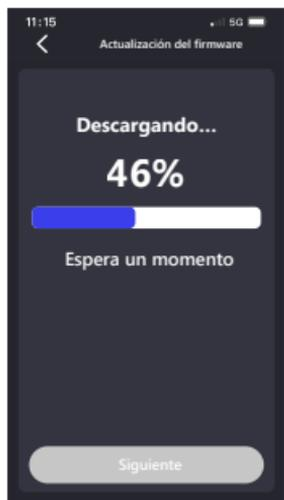
4. En ese momento, el teléfono transmitirá el firmware descargado al dispositivo mediante la función de enlace inalámbrico.
