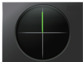
Signal de porteuse non modulée
