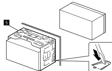
Savijte pločice rukavca za postavljanje pomoći odvijača ili sličnog alata i pričvrste ga na mjesto.
