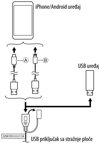
Ⓐ Za spajanje vašeg Android uređaja, koristite USB kabel (komercijalno dostupan)
