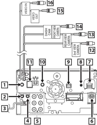
**1** Am Lenkrad-Fernbedienungskabelbaum des Fahrzeugs anschließen. Wenden Sie sich für Einzelheiten an Ihren KENWOOD-Händler.
