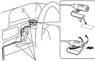
Befestigen Sie das Kabel mit handelsüblichem Klebeband.
