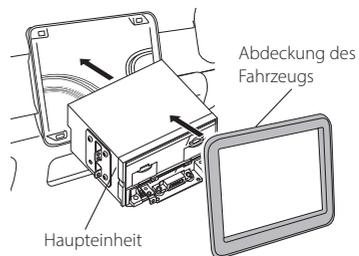
**6** Installieren Sie die Anzeigeeinheit (Zubehör ⑧) an der Haupteinheit.
