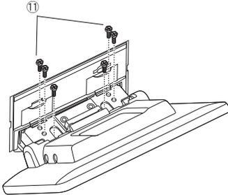
**8** Befestigen Sie die Schutzabdeckung (Zubehör ④) am Kupplungsstück und befestigen Sie sie dann mit zwei Kopfschrauben (Zubehör ⑤).
