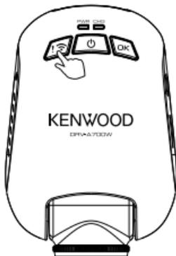
Appuyez et maintenez enfoncé le bouton Wireless Link sur l'appareil pendant 3 secondes pour entrer dans le mode d'appairage.
