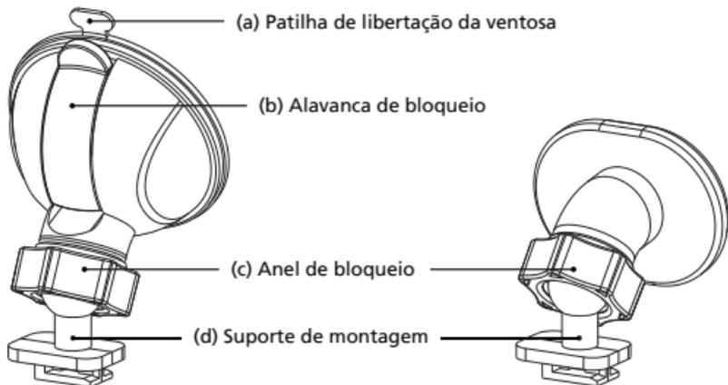
A embalagem inclui dois tipos de suportes. Um suporte de ventosa e um suporte adesivo. O suporte de ventosa torna mais fácil instalar e desinstalar no para-brisas e o suporte adesivo oferece um suporte mais sólido à câmara.
