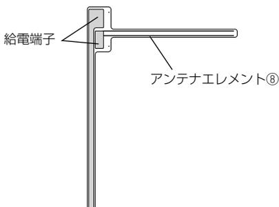
8. アンテナケーブル⑨のアンブ部裏面の剥離紙をはがし、アンテナエレメント⑧の給電端子に、アンテナケーブル⑨のアンブ部を貼り付けます。
