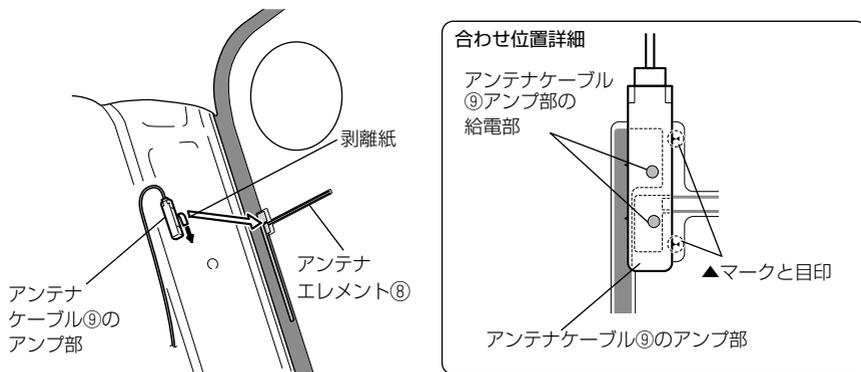
9. アンテナケーブル⑨を配線します。必要に応じてケーブルをソフトテープ⑩で固定して配線します。
