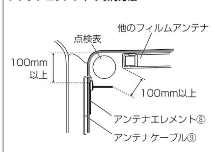
アンテナエレメント⑧の給電端子がフロントガラス周縁のセラミック部分またはフロントピラーの端から25mm以内の位置になるように貼り付けてください。
