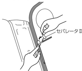
**7.** 樹脂製のヘラなどでフィルムの上からアンテナエレメント⑧を十分に密着させた後、保護フィルムⅢを静かにはがします。
