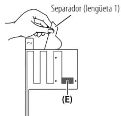
No toque la superficie adherente (lado del adhesivo) de la antena tipo película (E).
