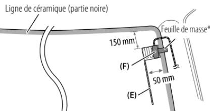
\* Collez la feuille de masse de l'amplificateur (F) sur la partie métallique du pilier avant.
