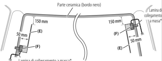
\* Incollare la lamina di collegamento a massa dell'amplificatore (F) sul montante anteriore del veicolo.
