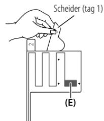
Raak het plakoppervlak (plakzijde) van de stripantenne (E) niet aan.
