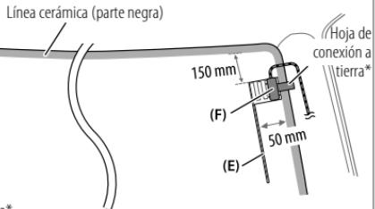
\* Pegue la hoja de conexión a tierra del amplificador (F) sobre la parte metálica del montante delantero.
