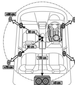
現在選んでいるリスニングポジションからすべてのスピーカーまでの距離を以下の手順で登録すると、ディレイタイムが自動的に計算され設定されます。
