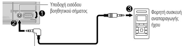
Στερεοφωνικό μίνι βύσμα 3,5 mm με συνδετήρα σχήματος L (διαθέσιμο στο εμπόριο)
