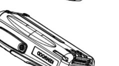
3 Terwijl u de ontgrendelknop ingedrukt houdt, trekt u de batterij van de zendontvanger af.
