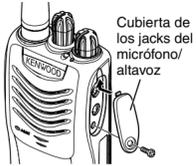
Si no está utilizándose un micrófono/ altavoz, instale la cubierta sobre los jacks del micrófono/ altavoz con el tornillo de M3 x 6 mm suministrado.
