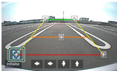
**4** Ajuste de la posición de la marca seleccionada.
