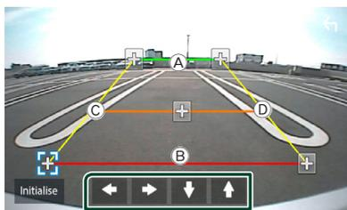
Asegúrese de que **(A)** y **(B)** estén paralelamente horizontales, y de que **(C)** y **(D)** tengan la misma distancia.
