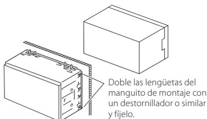
Doble las lengüetas del manguito de montaje con un destornillador o similar y fjelo.
