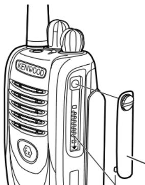
Setzen Sie die Abdeckung auf den Universalanschluss, und ziehen Sie die Schraube an.
