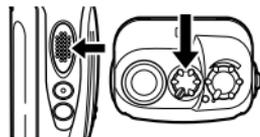
Drücken Sie die **PTT**-Taste einmal und lassen Sie ihn wieder los. Stellen Sie dann durch Drehen des **Kanal**-Wählers den gewünschten Kanal ein.
