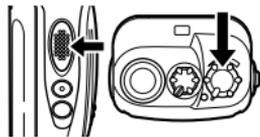
Schalten Sie den Transceiver AUS. Drücken und halten Sie dann die **PTT**-Taste, während Sie den Transceiver durch Drehen des Hauptschalters Einschalten.
