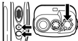
Schalten Sie den Transceiver AUS. Drücken und halten Sie dann die **Ruf-** und **Monitor-**Taste, während Sie den Transceiver durch Drehen des Hauptschalters Einschalten.
