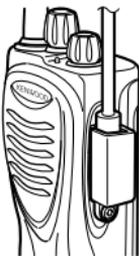
Schließen Sie bei Ausgeschaltetem Gerät die Sprechgarnitur an den Transceiver an {Seite 8}.
