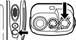
Drücken und halten Sie die **Monitor-Taste**, um das Hintergrundrauschen hörbar zu machen, und stellen Sie die Lautstärke durch Drehen am **EIN-/AUS-Schalter/ Lautstärke-Regler** wie gewünscht ein.
