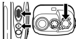
Schalten Sie den Transceiver AUS. Drücken und halten Sie dann die **PTT**-Taste und die **Ruf**-Taste, während Sie den Transceiver durch Drehen des Hauptschalters Einschalten.
