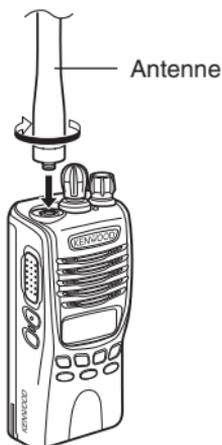
Vissez l'antenne sur le connecteur au sommet de l'émetteur-récepteur en tenant l'antenne par la base et en la tournant dans le sens horaire jusqu'à la fixer correctement en place.
