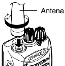
Sujete la antena por su base y enrósquela en el conector de la parte superior del transceptor girándola hacia la derecha, hasta que quede asegurada.
