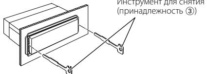
3. Опустите инструменты для снятия вниз, и нажимая внутрь, выдвиньте устройство наполовину.
