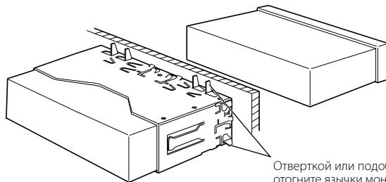
Отверткой или подобным инструментом отогните язычки монтажной коробки и установите ее на место.
