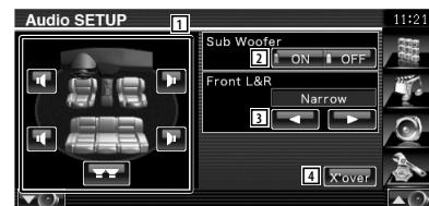
1 Выбор акустических систем для настройки разделительного фильтра. См. <Настройка разделительного фильтра> (стр. 59).
