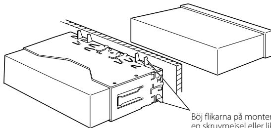
Böj flikarna på monteringskassetten med en skravmejsel eller liknande och sätt fast den på plats.
