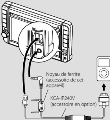
Le KCA-iP240V (accessoire en option) est nécessaire pour pouvoir connecter un iPod. Lors du raccordement, veillez à intégrer le noyau de ferrite fourni avec cet appareil pour éviter tout parasite électromagnétique (page 11).
