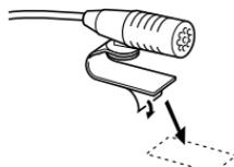
Ziehen Sie das Trägerpapier des doppelseitigen Klebebands ab, um die Befestigung an der oben gezeigten Stelle vorzunehmen.
