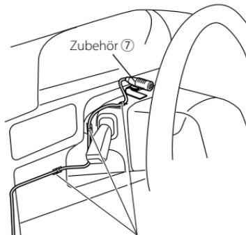
Befestigen Sie das Kabel mit Kabelklemmen (im Handel erhältlich)
