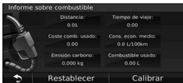
Los datos de consumo de combustible se basan en los cálculos de la velocidad y aceleración de un vehículo medio.
