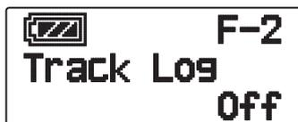
Beim Einschalten der Track Log-Funktion wird ca. 5 Sekunden „Log Start“ angezeigt, danach das Symbol „iLOG“.
