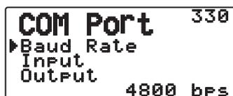
Stellen Sie die Kommunikationsgeschwindigkeit des externen GPS oder anderen Geräts ein, das an den GPS-Anschluss angeschlossen ist. Die Geschwindigkeit ist auf 4800 bps (NMEA) / 9600 bps (IPS-Format: SONY) eingestellt, wenn ein GPS-Receiver angeschlossen ist.
