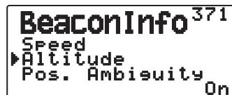
Spécifiez si l'altitude doit être ou non indiquée lors de la transmission des données APRS.
