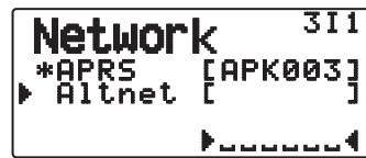
Réglez les communications de données APRS sur UNPROTOCOL. UNPROTOCOL est la méthode qui permet la transmission de données de paquet sans autres stations ou sans effectuer de connexion.
