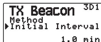
Vous pouvez changer l'intervalle de transmission automatique des paquets APRS. Sélectionnez 0.2, 0.5, 1, 2, 3, 5, 10, 20, 30 ou 60 minutes. Le réglage par défaut est 1 minute.
