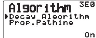
Cette fonction allonge progressivement l'intervalle de transmission des paquets lorsqu'il n'y a pas de changement de coordonnées.
