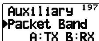
2 Réglez la bande de données sur "A-Band" (la bande A reçoit et transmet), "B-Band" (la bande B reçoit et transmet), "A: TX B:RX" (la bande A transmet (Tx) et la bande B reçoit (Rx)) ou "A: RX B:TX" (la bande A reçoit (Rx) et la bande B transmet(Tx)).
