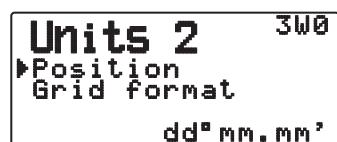
Sélectionnez "dd°mm.mm'" ou "dd°mm'ss.s" .
