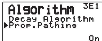
Cette fonction change automatiquement le chemin des paquets en fonction du temps écoulé.
