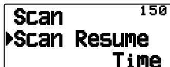
2 Réglez le mode Reprendre le balayage sur "Time" (commandé par le temps), "Carrier" (commandé par la porteuse) ou "Seek" (recherche).
