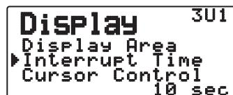
Le temps d'interruption peut être réglée sur 3, 5, 10 secondes ou "Infinite".
