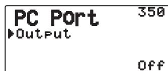
Cette fonction envoie les données par le port PC (USB) <Baud rate: 9600 bps> après la réception d'un paquet et des données de commande CTN lors de la transmission de données APRS. Utilisez cette fonction pour vérifier les données reçues depuis l'émetteur-récepteur.
