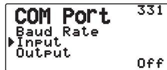
**Off:** vous pouvez effectuer des communications APRS sans utiliser un récepteur GPS externe ou une Station météo. Réglez vos données de position de station manuellement via le Menu 360 (MY Position) ou utilisez le récepteur GPS interne.
