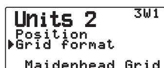
Sélectionnez "Meidenhead Grid", "SAR Grid (CONV)" ou "SAR Grid (CELL)".
