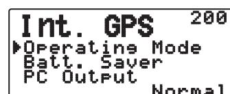
**GPS Only** : L'afficheur montre uniquement les informations de GPS; les capacités de transmission et de réception de l'émetteur-récepteur sont désactivées; seul le fonctionnement du GPS est disponible.
