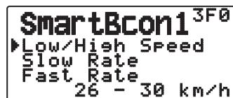
Réglage de faible vitesse (2 à 30 <mi/h, km/h ou knots>).
