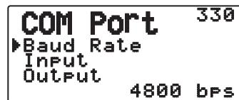
Réglez la vitesse de communication du GPS externe ou de l'autre appareil raccordé à la prise de GPS. La vitesse se règle sur 4800 bps (NMEA)/ 9600 bps (format IPS : SONY) lorsqu'un récepteur GPS est raccordé.
