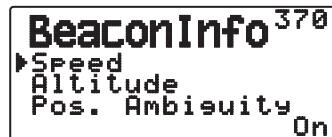
Spécifiez si la vitesse doit être ou non indiquée lors de la transmission des données APRS.
