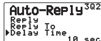
Après la réception d'un message, si vous utilisez l'émetteur-récepteur pendant la durée d'attente, avant que le message soit envoyé, le message automatique de réponse est annulé. Vous pouvez régler le temps d'attente sur 0, 10 ou 30 secondes. Le réglage par défaut est de 10 secondes.
