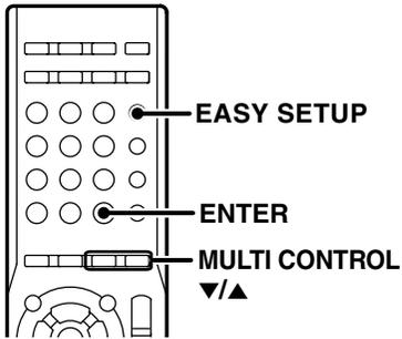
**1** Pulse [EASY SETUP] para entrar en el modo de configuración fácil.
