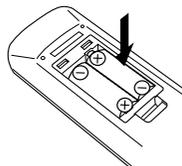
Inserte dos pilas (R03) siguiendo las indicaciones de polaridad.
