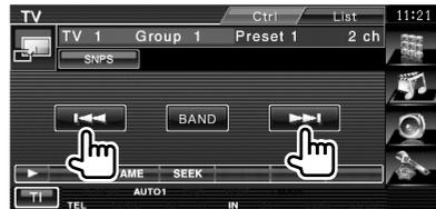
Die automatische Speicherung endet, wenn 6 Sender oder alle zu empfangenden Sender gespeichert sind.
