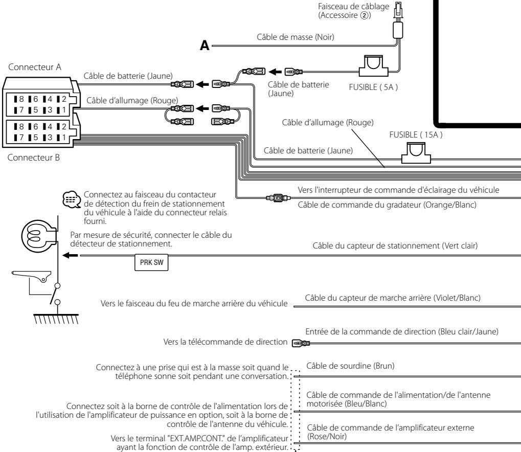
Connectez au faisceau du contacteur de détection du frein de stationnement du véhicule à l'aide du connecteur relais fourni.
