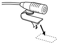
Оторвите разделительную бумагу двусторонней клейкой изоляционной ленты, чтобы прикрепить в месте, показанном на иллюстрации справа.
