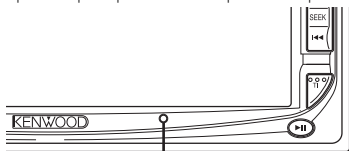
Tasto di ripristino
